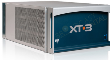
LSM EVS XT3 is een 8-kanaals toestel voor het mixen in real time preview mode.
